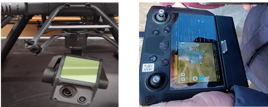
Figura 2. Sen sor LiDAR y emisora de componentes de UAV DJI MATRICE 300 RTK.
