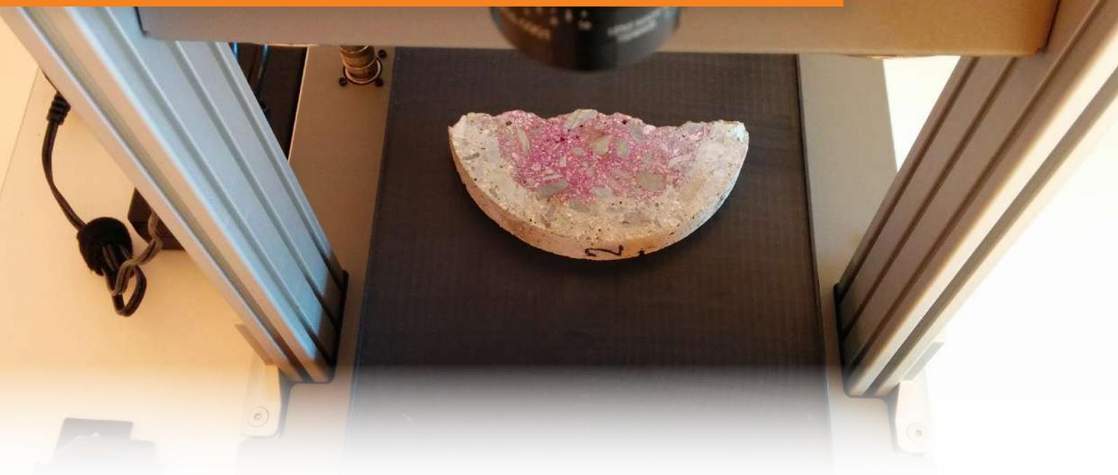
*Análisis de las muestras de hormigón con cámara hiperespectral*
