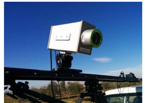
Montaje de cámara hiperespectral para el muestreo en campo
